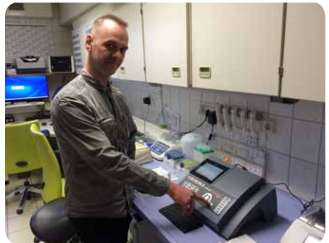
Abb. 3: Optisch reagenzienfreie Messung der Parameter CSB und Nitrat mit dem WTW-Photometers photoLab® 7600.
